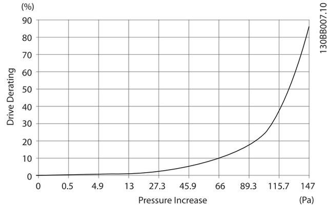
Рисунок 4.20: Корпус D Снижение значений относит. Изменение давления
