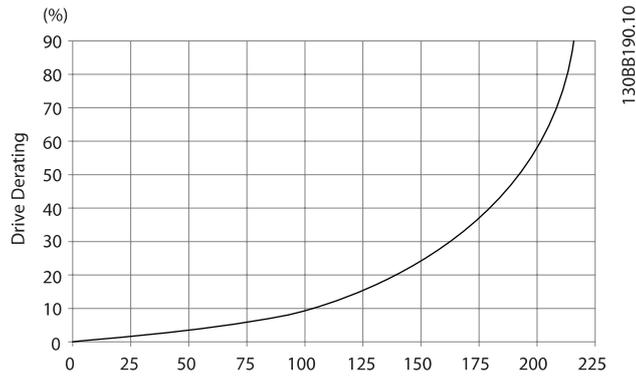
Рисунок 4.23: Корпус F, снижение значений относит. Изменение давления
