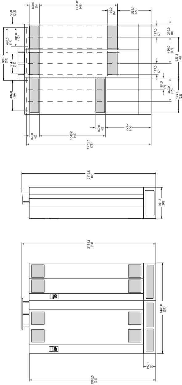
Рисунок 4.6: Типоразмер корпуса E7
