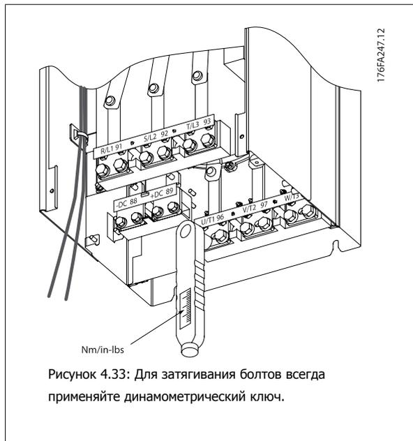
Рисунок 4.33: Для затягивания болтов всегда применяйте динамометрический ключ.
