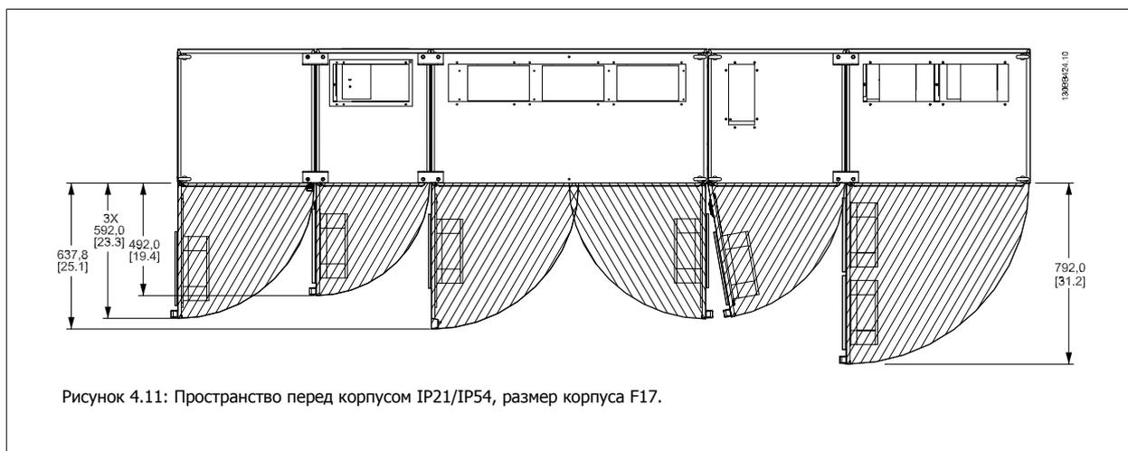
Рисунок 4.11: Пространство перед корпусом IP21/IP54, размер корпуса F17.
