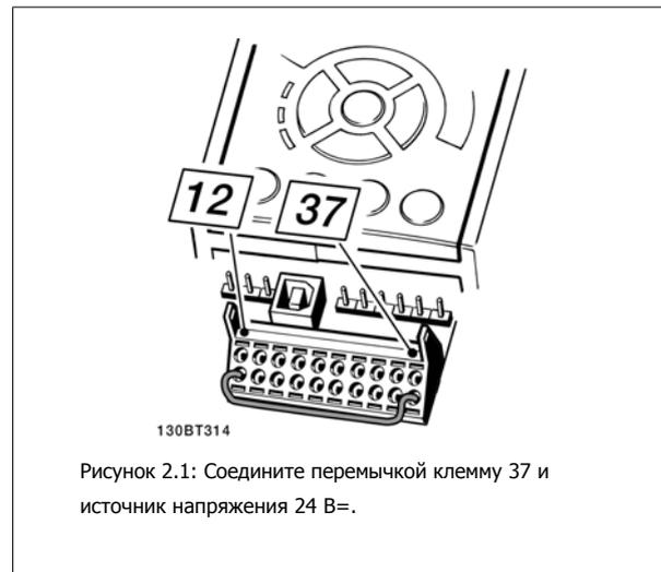
Рисунок 2.1: Соедините перемычкой клемму 37 и источник напряжения 24 В=.
