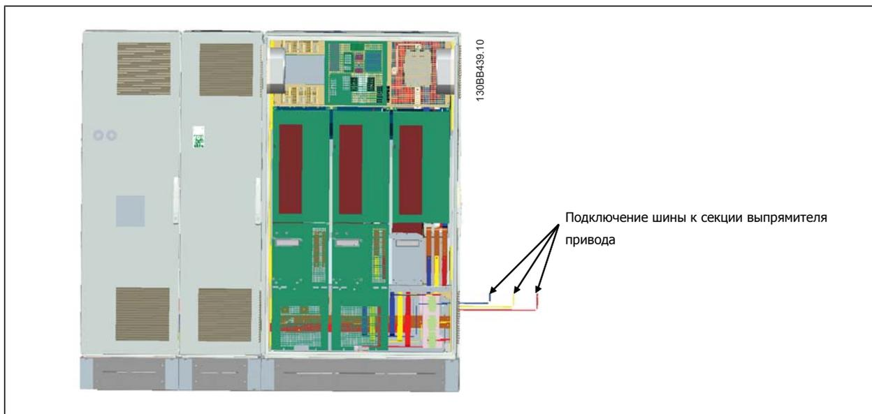
9. После подключения сетевых шин можно установить на место нижние крышки на секциях LCL и выпрямителя.
