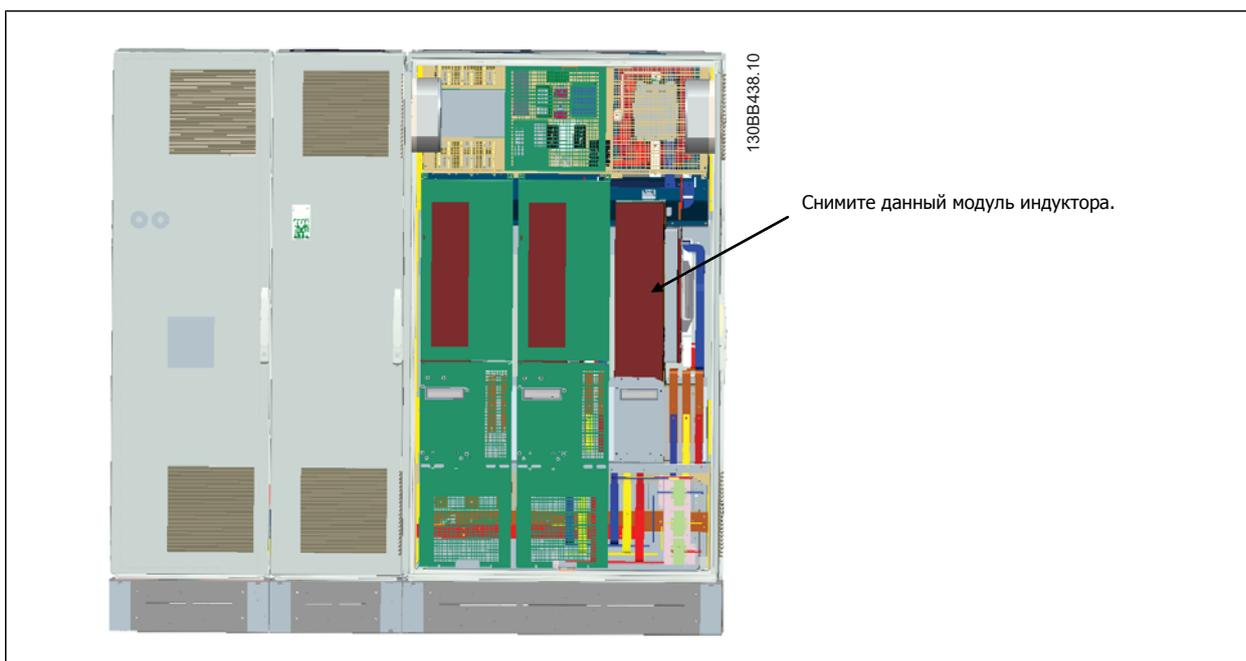
6. После снятия модуля индуктора секции фильтра и привода можно соединить. Для их соединения потребуется использовать четырех угловых скобы и шесть боковых скоб. Скобы находятся в пакете вместе с соответствующими винтами. После установки внутренних скоб следует установить две верхних "L"-образных скобы, которые будут служить точкой опоры для передвижения всего узла.
