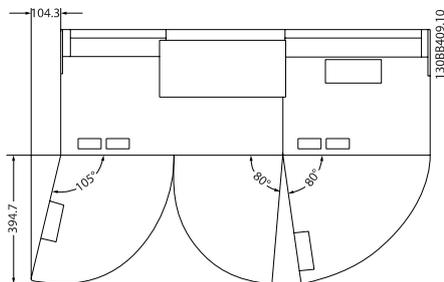
Рисунок 4.9: Пространство перед корпусом IP21/IP54, размер корпуса D11.
