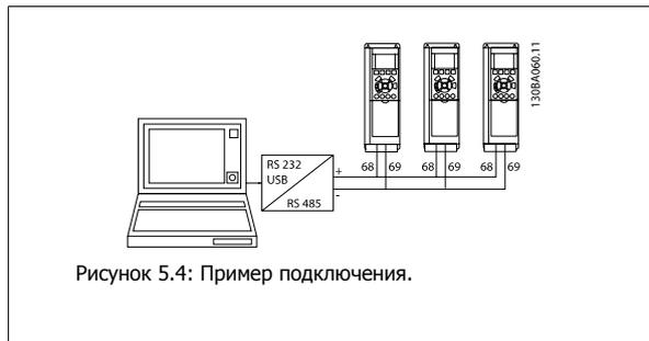
Рисунок 5.4: Пример подключения.
