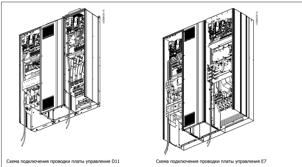
Схема подключения проводки платы управления D11
