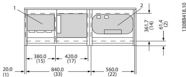
Кабельные вводы преобразователя частоты (вид снизу)
