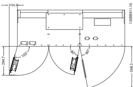
Рисунок 4.10: Пространство перед корпусом IP21/IP54, размер корпуса E7.
